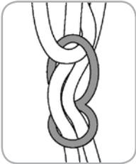
Die Höhe der Nestschaukel kann durch die Öffnungen in dem Verstellelement eingestellt werden. Dadurch kann die Länge der Seile entsprechend verändert werden. Beim Einstellen der Seillänge sollte niemand auf der Schaukel sitzen. Achten Sie darauf, dass die Seile immer gleichlang sind.
