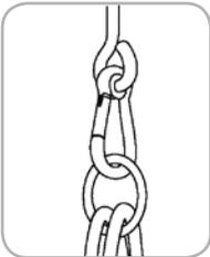
Das Auge der Halterung muss quer zur Schaukelrichtung angebracht werden. Dadurch wird ein zu großer Verschleiß beim Schaukeln verhindert.
