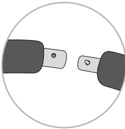
3. Achten Sie darauf, dass jeweils ein dickeres Rohrende mit Loch auf ein Rohrende mit Federdruckknopf folgt.
