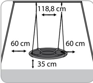
Os pontos de suspensão têm de ser distanciados entre eles, no mínimo, com a mesma largura do assento do balanço (+ 10 cm).
