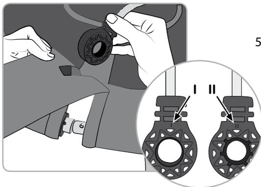
5. Meter a suspensão em material sintético da corda pela abertura da tala com as tiras de velcro, de cima para baixo. De seguida, meter a suspensão no tubo mais grosso com o lado II (veja a marcação).
