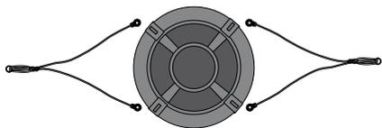
4. Colocar as duas cordas com as suspensões em material sintético na sequência correta ao lado do baloiço de ninho. Tenha cuidado para que as cordas não estejam torcidas.
