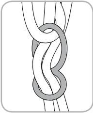
A altura do balanço de ninho pode ser ajustada através das aberturas do elemento de ajuste. Assim, se pode alterar devidamente o comprimento das cordas. Durante o ajuste do comprimento das cordas, ninguém deve estar sentado no balanço. Preste atenção para que todas as cordas tenham o mesmo comprimento.
