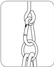
O olhal do suporte tem de ser montado no sentido transversal à direção de balançar. Assim evita-se um desgaste demasiado elevado durante a utilização.
